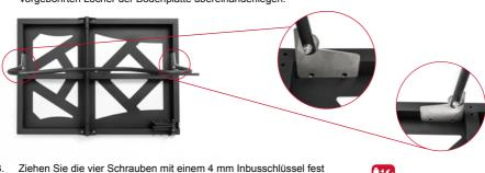
Ziehen Sie die vier Schrauben mit einem 4 mm Inbusschlüssel fes (Anzugsdrehmoment 9,5 Nm).
